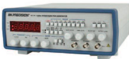
O modelo 4017A é um gerador de varredura de 10 MHz com display LED de 5 dígitos, varredura log-linear, ciclo de funcionamento variável e deslocamento CC.
