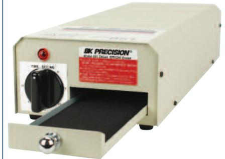
O modelo 851 é um apagador da EPROM de uso industrial capaz de apagar até 40 chips EPROM de vinte e quatro pinos simultaneamente. Tem um revestimento todo de metal e foi criado com uma gaveta de chip que impede que exposição à radiação UV cause danos ao usuário. A gaveta é forrada com espuma condutora para evitar danos eletrostáticos para os chips. Um cronômetro de 30 minutos é providenciado para controlar exposição à UV.
