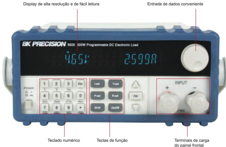
As cargas eletrônicas CC programáveis da **série 8500** podem ser usadas para testar e avaliar uma variedade de fontes de alimentação CC. Sua ampla variação de operação de até 500 V e 240 A, modos de operação flexíveis e precisão de cálculo excelente fazem a série 8500 adequada para caracterizar fontes de alimentação CC, conversores CC-CC, baterias, células de combustível e células solares.
