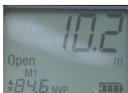
Exemple de mesure sur un câble avec une coupure à 10,2 m
