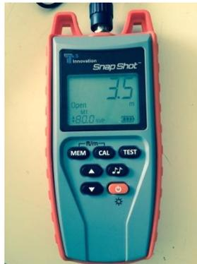
**4- Mesure de la longueur d'un câble réseau :**
