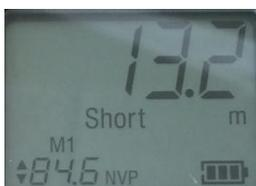
Exemple de mesure sur un câble en court-circuit à 13,2 m
