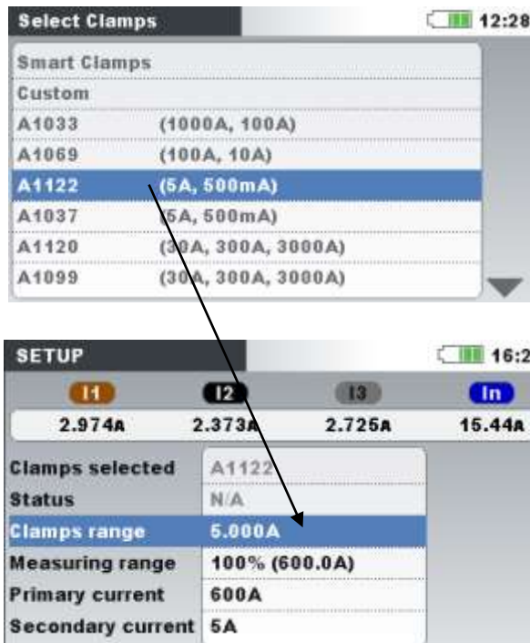
Image0.: Sélection des pinces de courant pour mesure du courant indirecte
