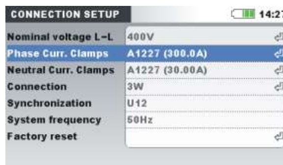
Image 0: Réglage de la reconnaissance automatique des pinces
