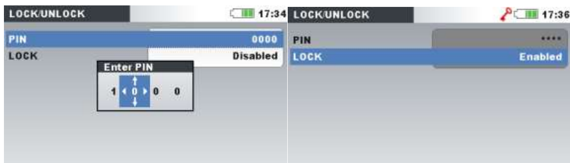
Image3.68: Ecran verrouillage / déverrouillage
