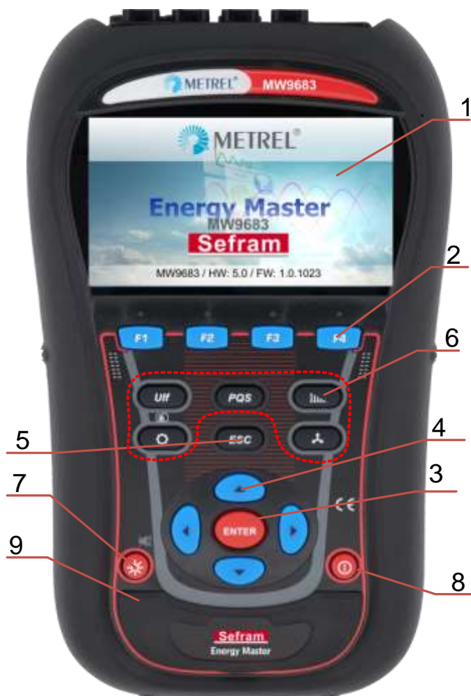
Image0.1: Face avant de l'appareil
