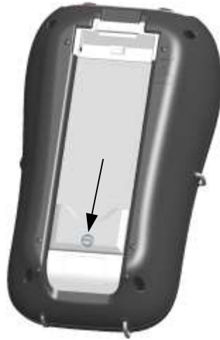
Image 0.2: Fermeture du couvercle du compartiment des piles
