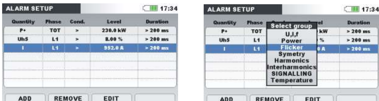
Image 3.61 Ecrans de configuration d'alarme
