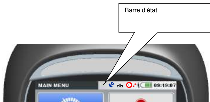
Image0.3: Barre d'état de l'appareil
