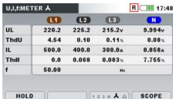
Image 3.57: Ecran de mesure U,I,f dans les données instantanées
