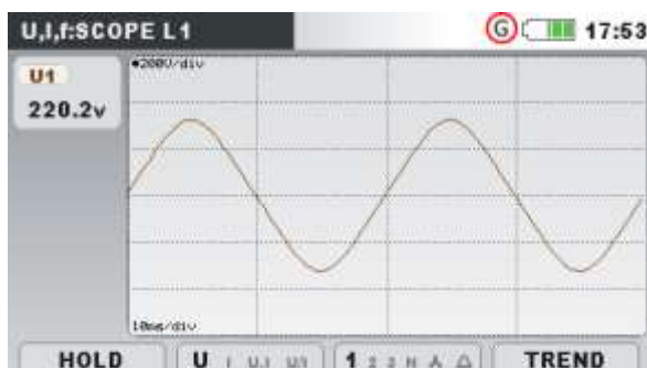
Image 0.12: Forme d'onde unique de tension
