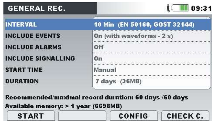
Image 0.18: Configuration de l'enregistreur prédéfini EN50160
