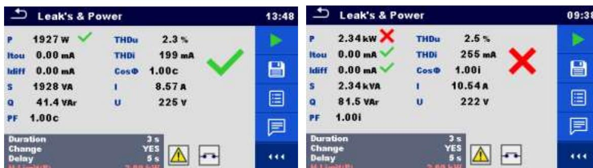
Image 6.56: Exemples de résultats de mesure de Fuite et de Puissance
