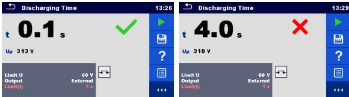
Image 6.60: Exemples de résultats de mesure du Temps de Décharge ( Sortie = Externe)
