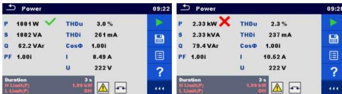
Image 6.53: Exemples de résultats de mesure de la Puissance
