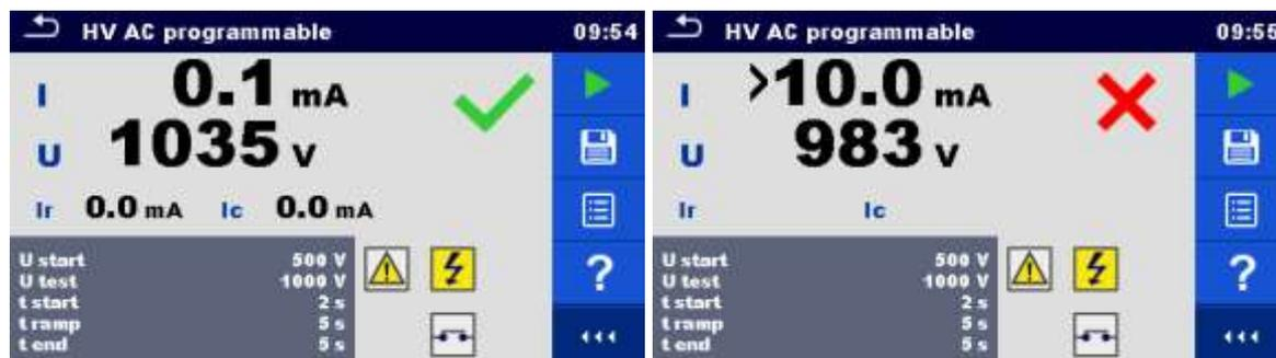
Figure 6.30: Exemples de résultats lors du test HT AC programmable
