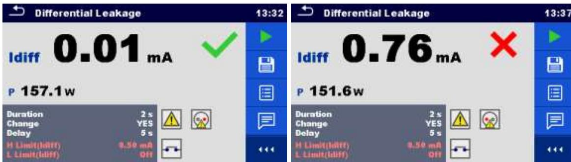
Image 6.45: Exemples de résultats de mesure de courant de fuite différentiel
