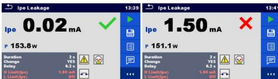
Image 6.48: Exemples de résultats de mesure du courant de fuite à la terre
