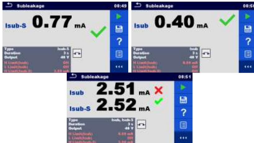
Image 6.42: Exemples de résultats de mesure du courant de fuite secondaire
