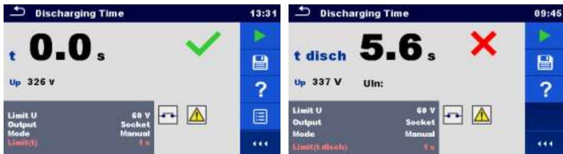
Image 6.62 : Exemples de résultats de mesure du Temps de Décharge ( Sortie = Prise)
