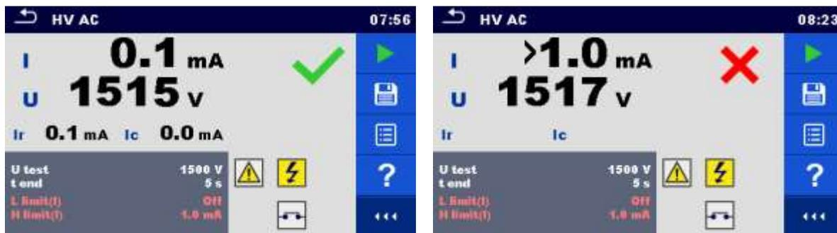
Image 6.23: Exemples de résultats de mesures lors du test HT AC
