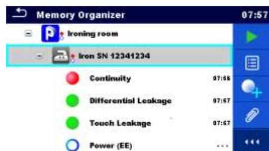
Image 5.5: Exemple de statut – Mesures non terminées avec un résultat en échec
