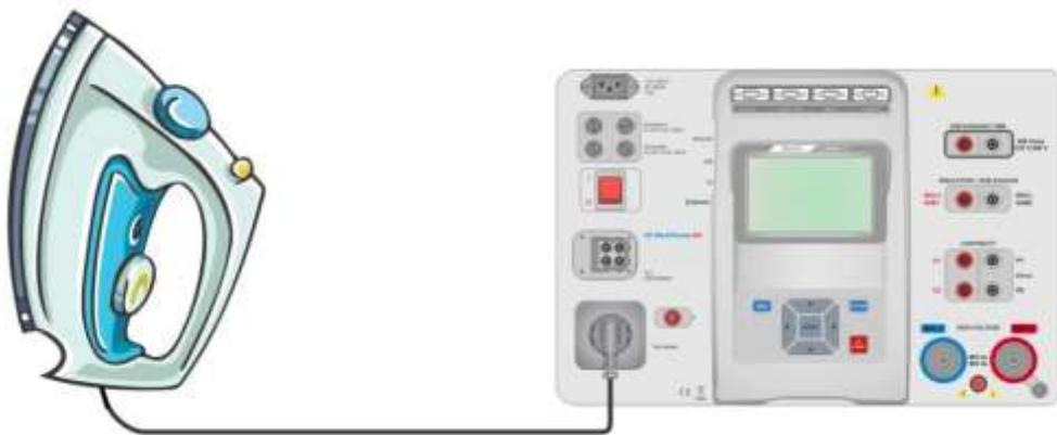
Image 6.40: Mesure de courant de fuite secondaire (Prise LN-PE)
