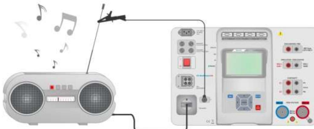
Image 6.50 : Mesure du courant de fuite de contact
