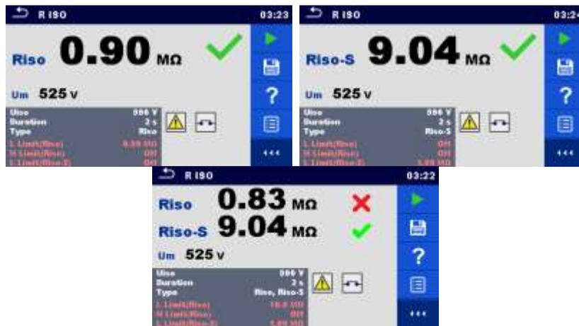
Image 6.37: Exemples de résultats de mesure de résistance d'isolement
