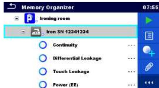
Image 5.4: Exemple de statut - Aucun résultat(s) de mesure
