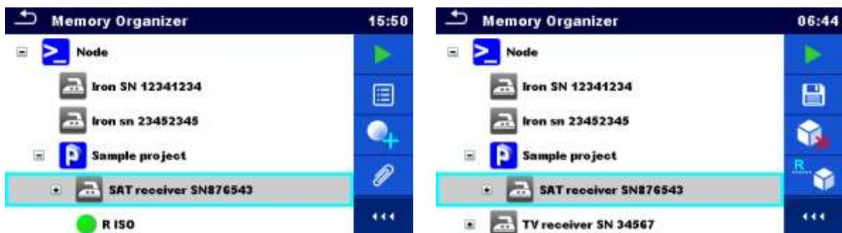
Image 5.8 : Sélection d'un objet de structure dans l'arborescence
