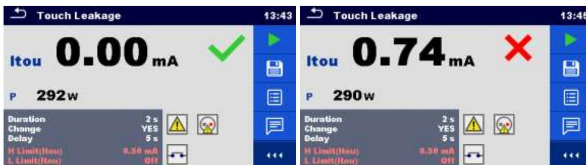
Figure 6.51: Exemples de résultats de mesure de courant de fuite de contact
