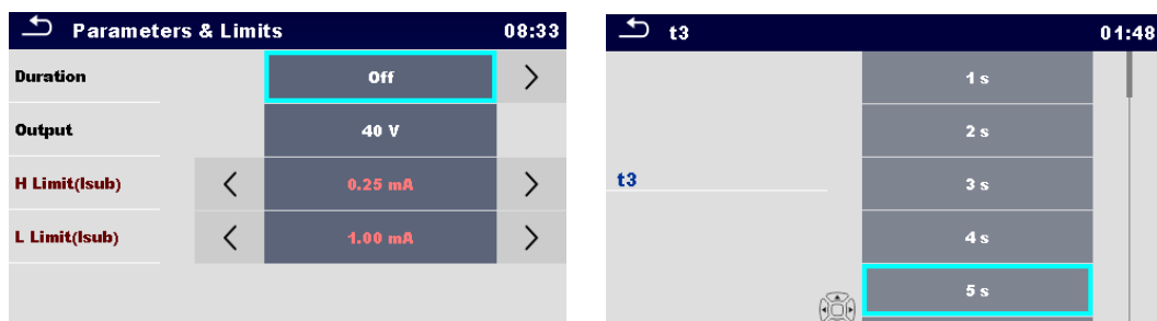
Figure 6.3: Écrans dans le menu pour le réglage des paramètres et des limites de test unique
