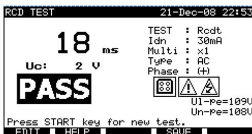
Exemple de résultats de mesure de temps de déclenchement d'un DDR
