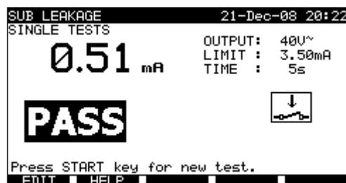
Exemples de résultats de mesure de courant de fuite par méthode de substitution
