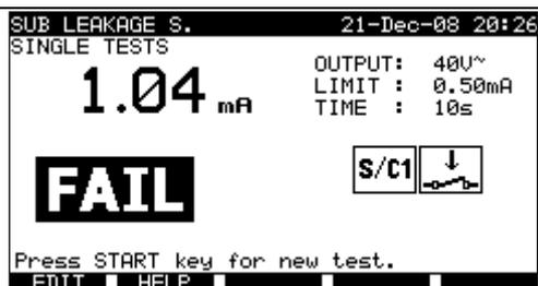
*Exemples de résultats de mesure de courant de fuite par méthode de substitution S*
