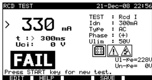
Exemple de résultats de mesure de courant de déclenchement d'un DDR
