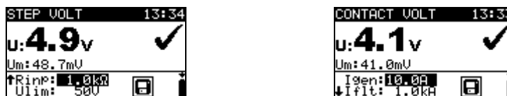
Image 7.10: Exemple de résultats de mesure de Tension de Pas et de Tension de Contact.
