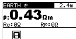
Image 7.15: Exemple de mesure de résistance de terre spécifique
