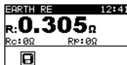
Image 7.13: Exemple de résultat de mesure de résistance de terre
