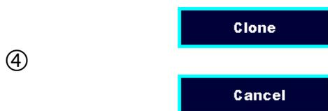
L'objet de structure sélectionné est copié (cloné) au même niveau dans l'arborescence.
