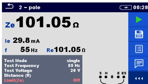
Figure 11.8 : Exemples de résultat de mesure à 2 piquets
