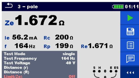
Figure 11.11 : Exemples de résultat de mesure à 3 piquets
