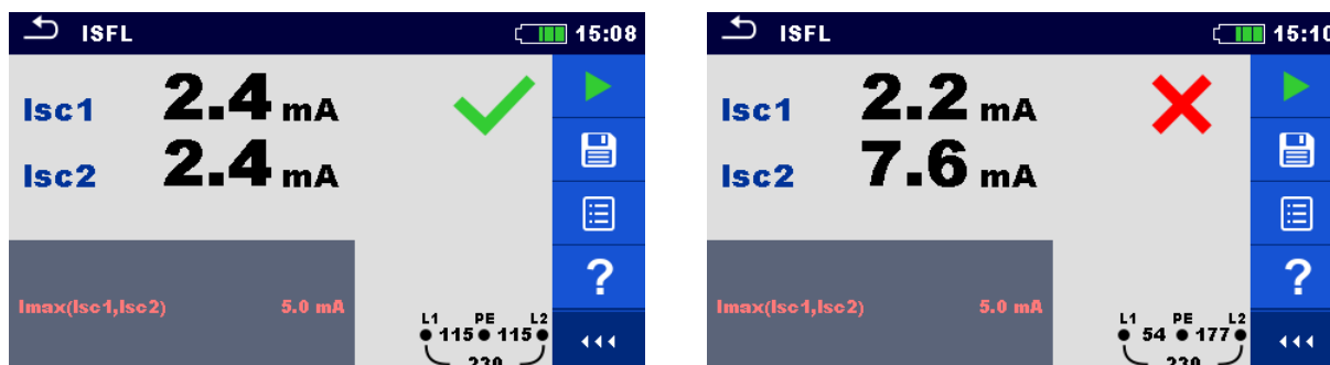
Image 4.92 : Exemples de résultats de mesure de courant de fuite premier défaut
