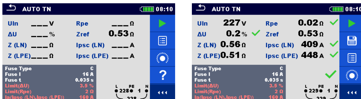
Image 4.114 : Exemples de résultats de mesure AUTO TN
