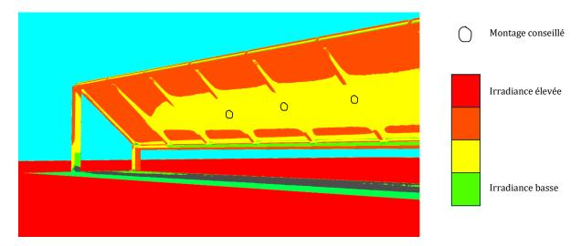
En cas de différentes configuration des modules OV dans une chaîne PV, la cellule de référence PV doit être placée au centre de la chaîne PV. Quelques placements recommandés de la cellule de référence PV d'irradiance sont marqués d'un point noir dans la figure ci-dessous.
