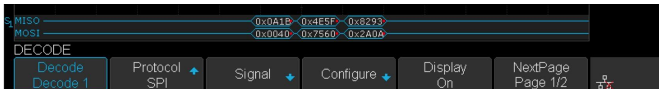
Figure 7.16 Affichage du bus de décodage SPI
