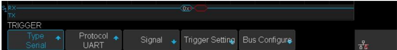
Figure 7.22 Affichage du bus de décodage UART
