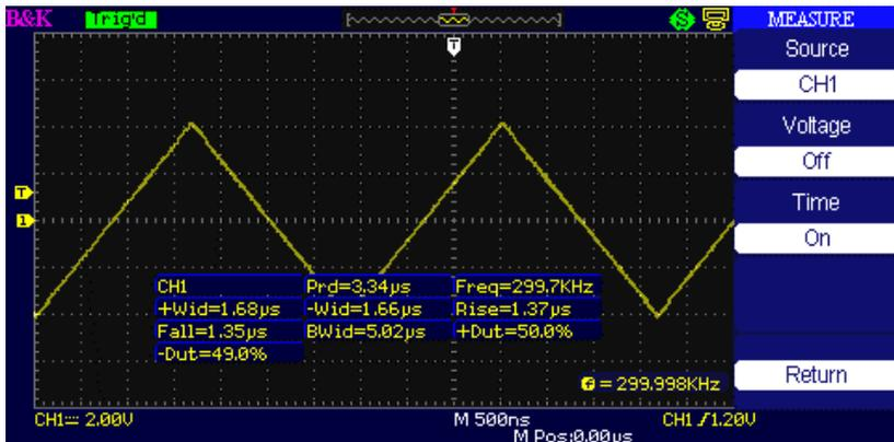
Figure 3.43 – Paramètres de mesure « All time »
