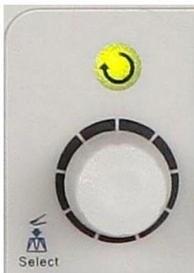
**Figure 3.4 – Roue codeuse universelle**
