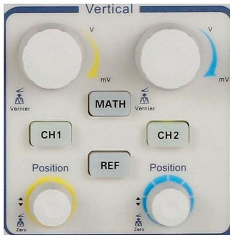
Figure 3.5 – Commandes du système vertical
