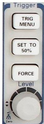
Figure 3.21 – Commandes de déclenchement
