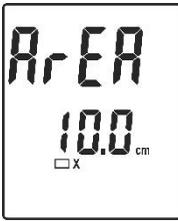
(4) Fig.4 Réglage de la dimension X d'un conduit rectangulaire.
