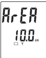
(5) Fig.5 Réglage de la dimension Y du conduit rectangulaire.
