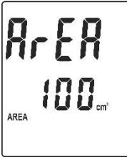
(2) Fig.2 Réglage de l'aire du conduit.
