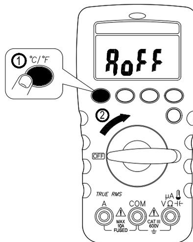
Positionnez le commutateur rotatif sur la position OFF, puis restez appuyé sur la touche de fonction et mettez en marche le multimètre.
