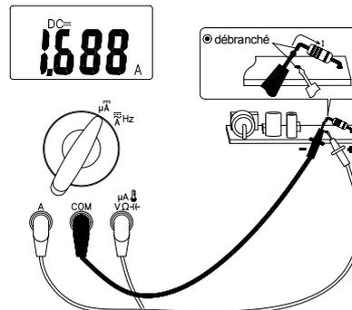
Positionnez le commutateur rotatif sur la fonction désirée et appuyez sur le bouton de fonction pour sélectionner la fonction.
