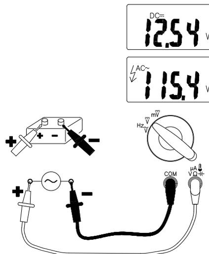
Positionnez le commutateur rotatif sur la fonction désirée et appuyez sur la touche de fonction appropriée pour sélectionner la fonction.
