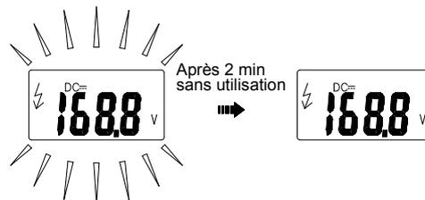
**Arrêt du rétroéclairage automatique (uniquement pour 7204)**
