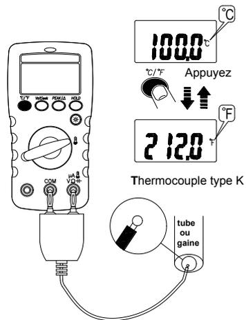
Positionnez le commutateur rotatif sur la position désirée et appuyez sur la touche de fonction pour sélectionner la fonction mesure.
