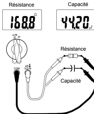
Positionnez le commutateur rotatif sur la position désirée et appuyez sur la touche de fonction pour sélectionner la fonction.
