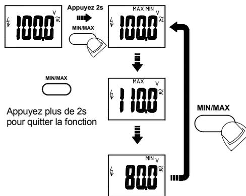
En fonction MIN MAX, la pince enregistre les valeurs MIN et MAX des mesures. Des appuis brefs permettent de consulter les valeurs enregistrées. Appuyez sur Hold pour arrêter l'enregistrement.
