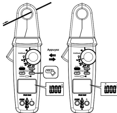
L'appareil émettra des bips de manière continue si la mesure est supérieure de 50 points à celle affichée (la détection entre courant AC et DC n'est pas possible).
