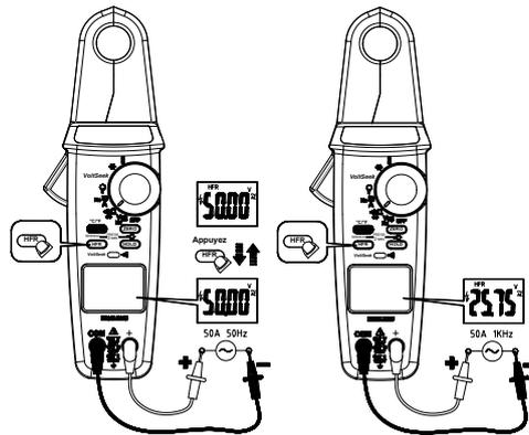
La fréquence de coupure du filtre est de 800Hz, avec une atténuation d'environ  $-24\text{dB/octave}$ .
