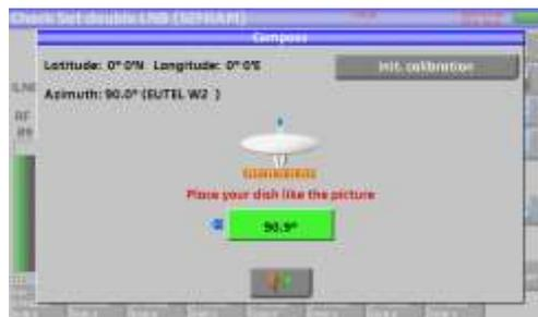
The « **init.calibration** » key relaunches the calibration of the compass.
