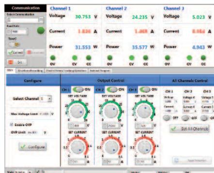
Um software para PC é disponibilizado para emulação do painel frontal, gerar e executar sequências de testes ou registro das medidas, sem a necessidade de programação em código fonte.
