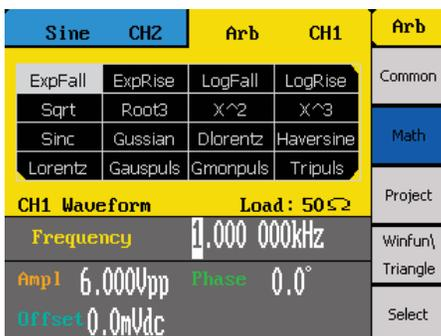
Todos os modelos da série 4050 possuem memórias não voláteis para criar, armazenar e posteriormente recuperar até 16 diferentes formas de onda arbitrárias de até 16.000 pontos. Os usuários podem também selecionar qualquer uma das 48 formas de onda arbitrárias pré-definidas internamente.
