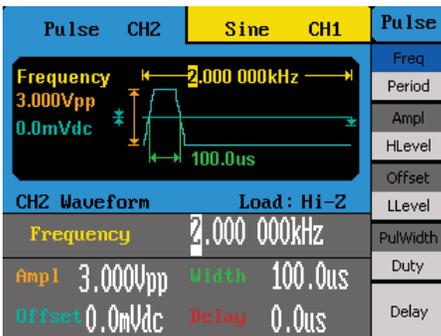
A tela colorida de 3,5" destaca o canal selecionado e mostra todos os parâmetros importantes com uma amostra da forma de onda sendo gerada.
