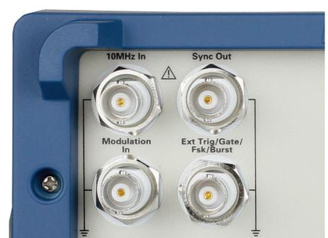
Use a entrada de clock externa de 10MHz para sincronizar seus sinais a uma base de tempo principal. A saída Sync gera um pulso TTL para sincronização a uma frequência do canal. Um conector de trigger externo está também disponível para entrada ou saída de sinais de trigger.
