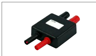
989006000: 1 ohm shunt, 0,1%, 0,5A max
