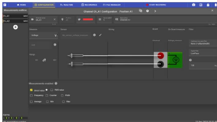
Le menu de configuration des voies est conçu de manière intuitive pour faciliter le paramétrage des mesures. Le schéma de connexion change pour afficher les informations de câblage correspondant au type de mesure et au capteur sélectionné.
