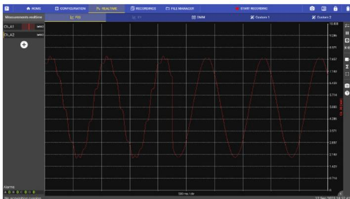
Réduisez les bruits indésirables grâce aux filtres analogiques et numériques intégrés. Les filtres analogiques comprennent des filtres passe-bas de 100 Hz, 1 kHz et 10 kHz. Le filtrage numérique comprend un filtre passe-bas définissable par l'utilisateur entre 10 mHz et 10 kHz.
