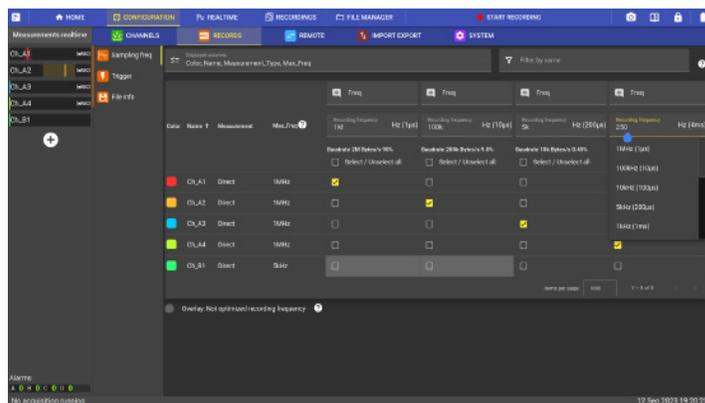
Enregistrement simultané de données avec 4 fréquences d'échantillonnages différents configurables par l'utilisateur. Enregistrez des voies à des vitesses plus faibles ou plus élevées pour une optimisation de l'espace de stockage.
