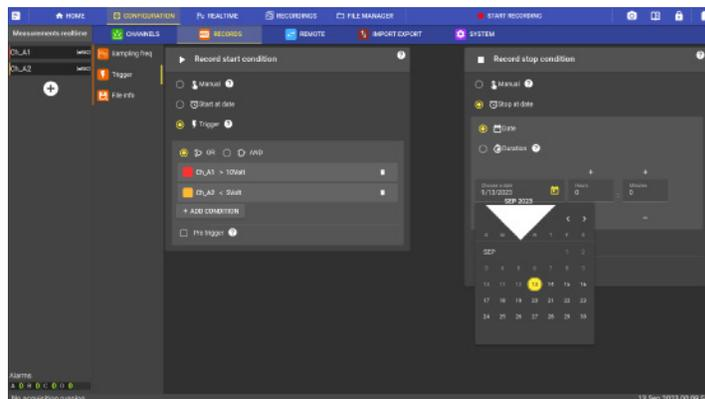
Configurez les paramètres de déclenchement pour démarrer et arrêter l'acquisition manuellement, à un moment précis, ou par une combinaison d'une ou de plusieurs voies.
