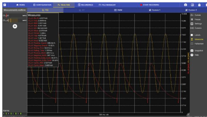
Calculs automatiques jusqu'à 19 mesures différentes comme l'amplitude, la valeur efficace, la moyenne, la fréquence, le temps de montée et le temps de descente.
