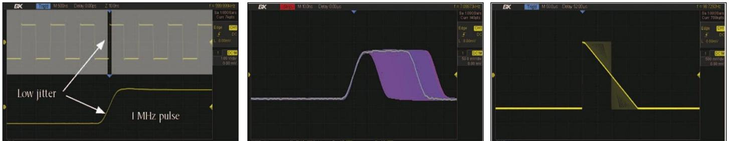
Cette série est équipée d'un traitement de signal numérique avancé pour réduire le jitter et produire des formes d'onde d'impulsion très stables.
