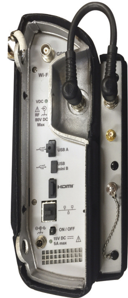
Module optique sur un mesureur SEFRAM 7876
