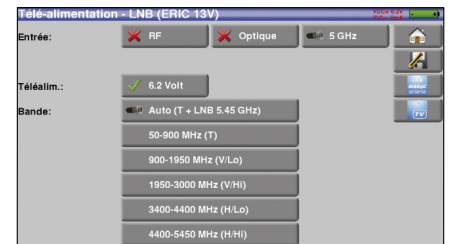
Entrée 5.4GHz: choix de la bande convertie et possibilité de téléalimentation
