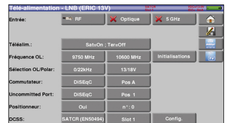
Entrée 5.4GHz: choix de la bande convertie et possibilité de téléalimentation
