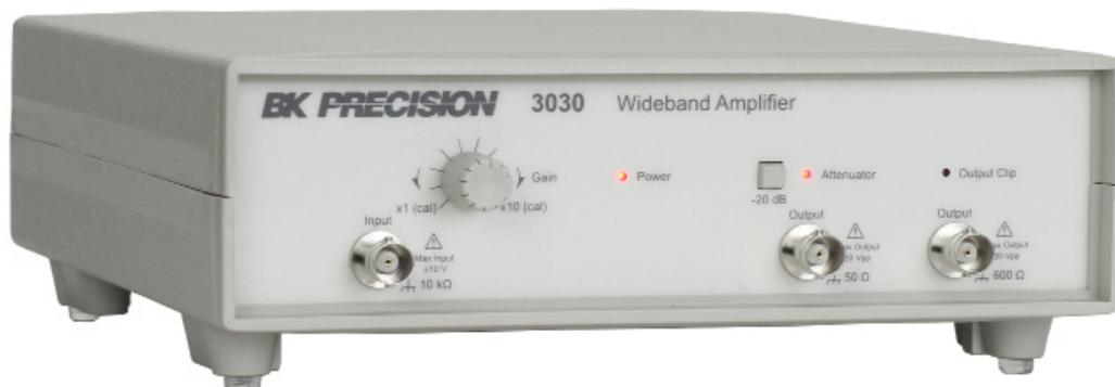
Le 3030 est un amplificateur DC à 1MHz avec une sortie maximale de 30 volts crête à crête à partir d'une impédance de source de 50 Ω. Une sortie de 600 Ω est également fournie. L'unité peut délivrer jusqu'à 15 volts crête à crête dans une charge de 50 Ω et peut conduire jusqu'à 300 mA crête dans une faible impédance ou un court-circuit.
